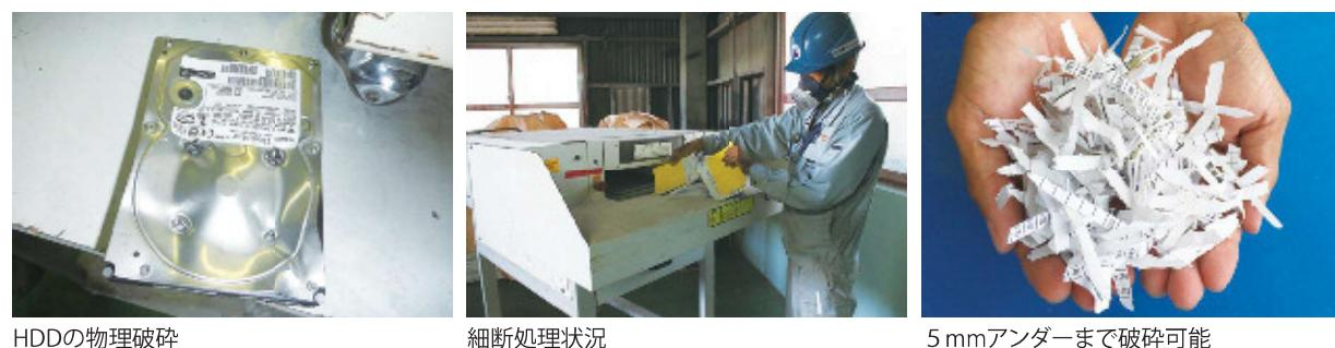
HDDの物理破碎 細断処理状況 5 mmアンダーまで破碎可能
